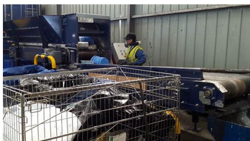
Figure 16 : Illustration des activités de broyage d'EMS et de déchiquetage de plastiques du groupe CHIMIREC
