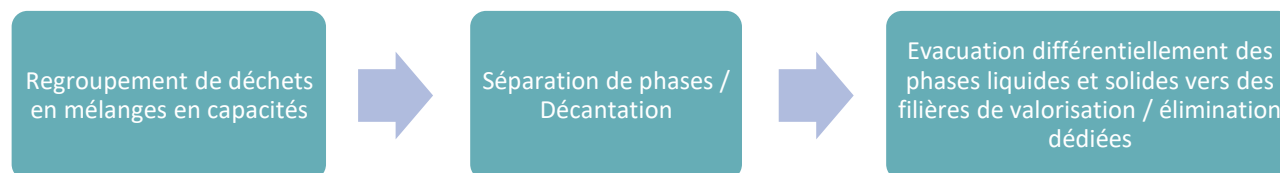
Figure 25 : Synoptique simplifié de l'activité de traitement par séparation de phase de déchets
