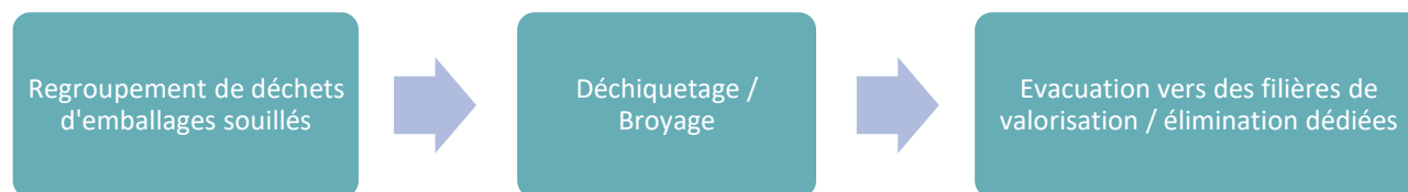
Figure 26 : Synoptique simplifié de l'activité de déchiquetage / broyage d'emballages souillés
