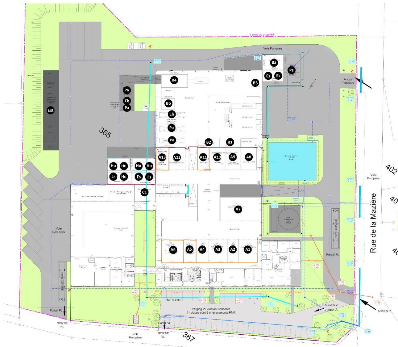
Figure 18 : Plan de masse annoté du site CHIMIREC Est de Wisches : détail des aires et capacités d'entreposage de déchets
