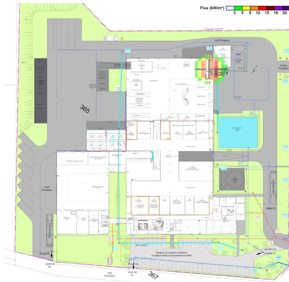
Modélisation des distances d'effets du scénario d'incendie de l'entreposage d'emballages non souillés en plastiques : alvéole B3
