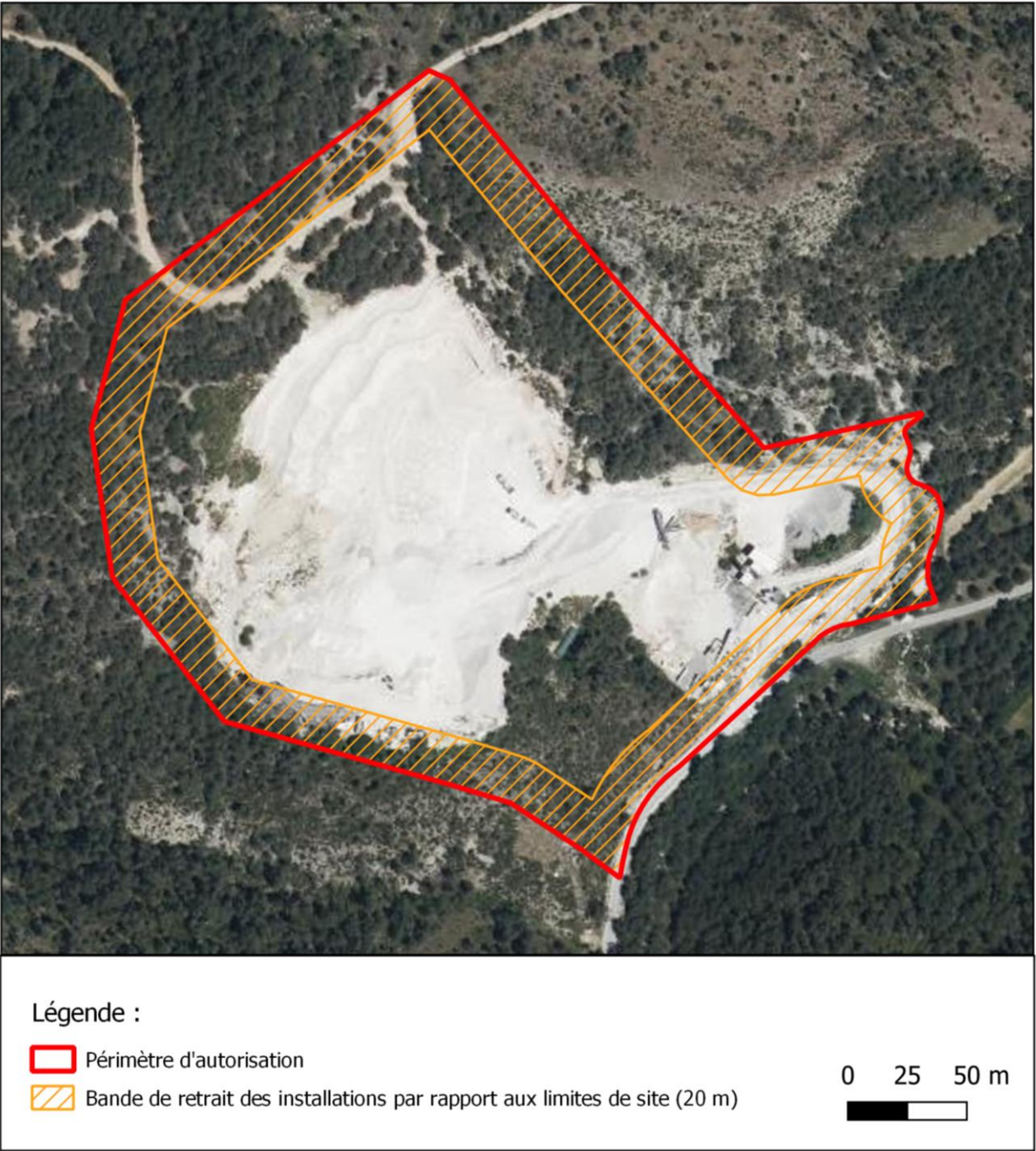
Figure 1. Installation de traitement située au minimum à 20 m des limites du site (Source : Géoenvironnement)
