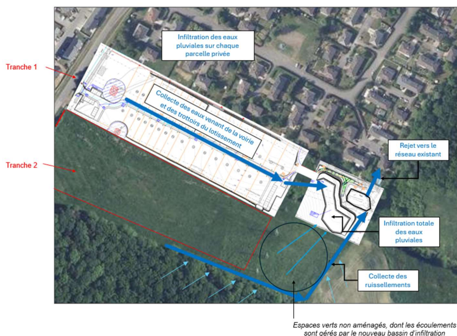
Figure 2. Cartographie des écoulements au sein et en amont du projet, avec aménagements projetés.
