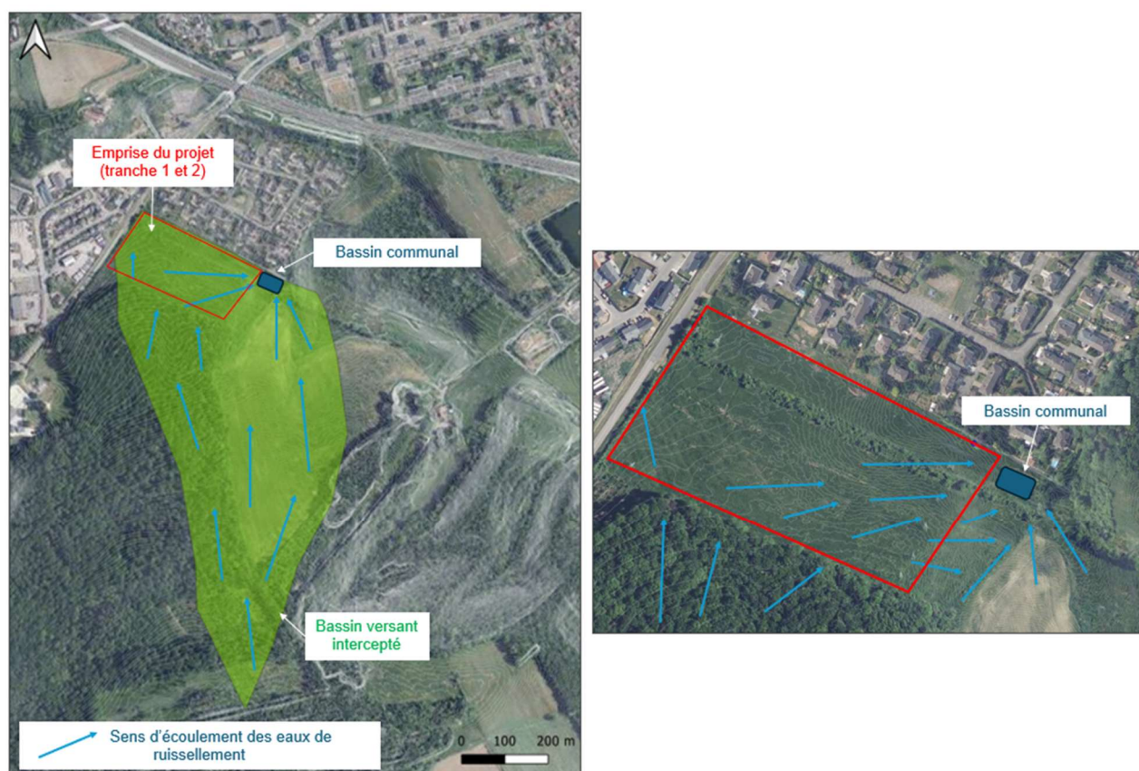
Figure 1. Cartographie des écoulements au sein et en amont du projet, avant aménagements.
