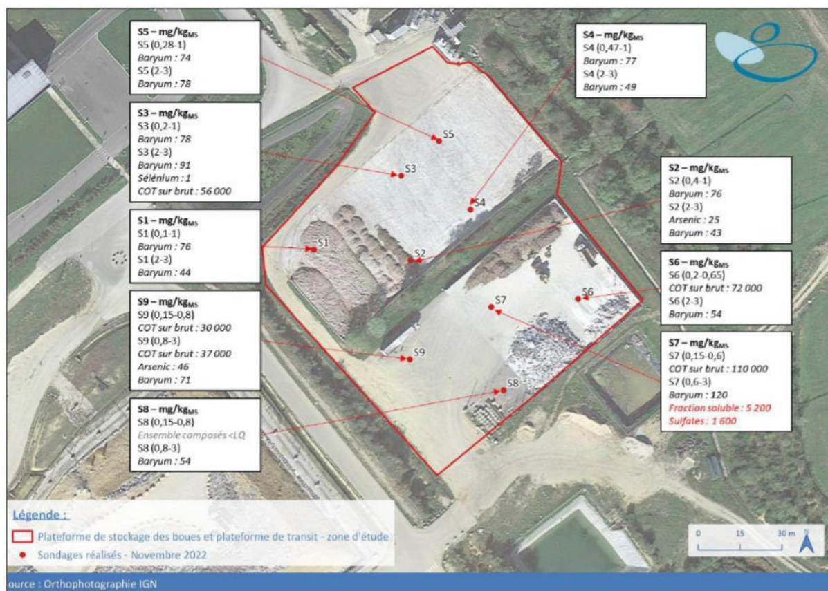
Figure 24 : Cartographie des résultats analytiques - Diagnostic environnemental plateforme de transit (source : rapport Antea Group n° rapport n°A119778/VA du 21/12/2022)
