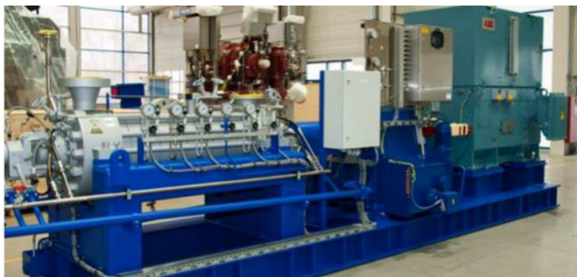
Figure 43 : Exemple de pompe alimentaire de chaudière
