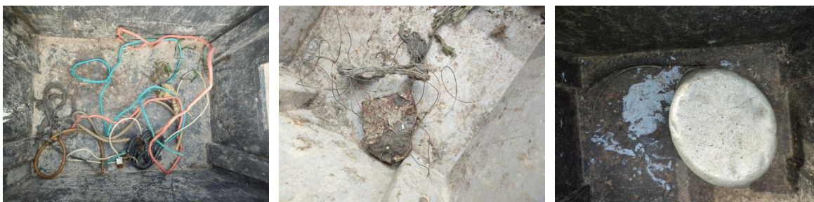
Figure 42. Exemples d'éléments non valorisables au sein du refus : câbles électriques, emballages métalliques et autres métaux
