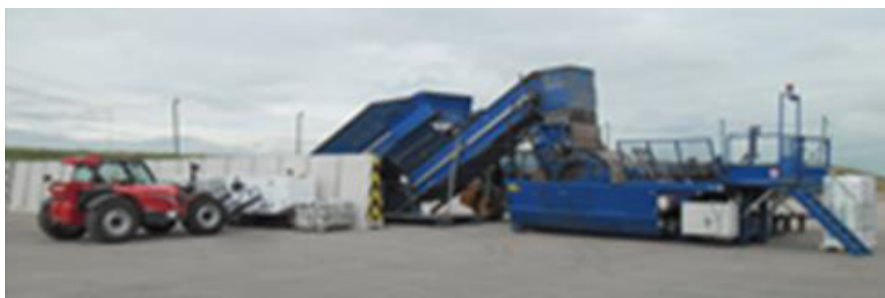
Figure 19 : Presse enrubanneuse mobile avec convoyeur utilisée pour la mise en balles
