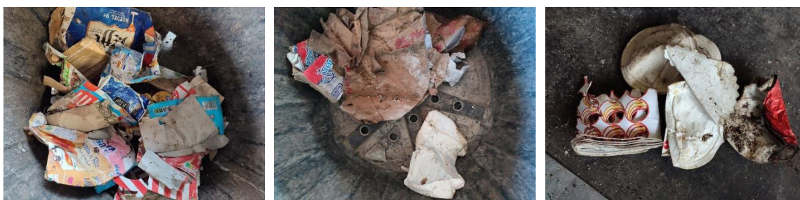
Figure 13. Exemples de cartons présents au sein des OMR : emballages cartons plats, emballages cartons ondulés, autres cartons.
