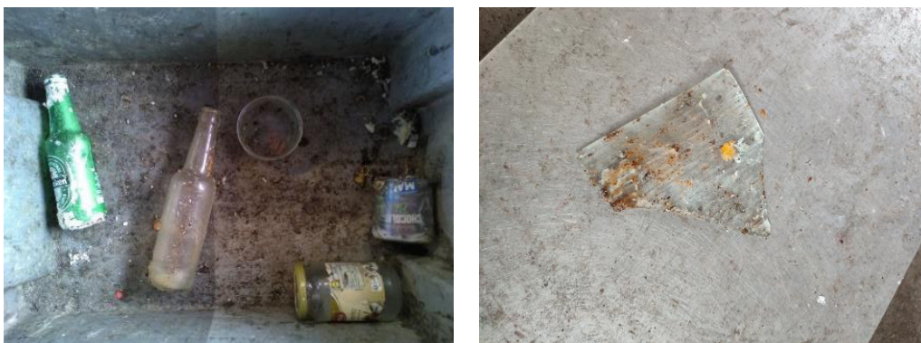
Figure 24. Exemples de verres présents au sein des OMR (« emballages en verre » et « autres verres »).
