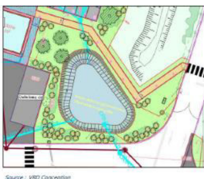
Figure 48 : Implantation du nouveau bassin tampon étanche de rétention des eaux pluviales pour la zone de stationnement et le chemin piéton desservant le nouveau bâtiment « locaux sociaux »
