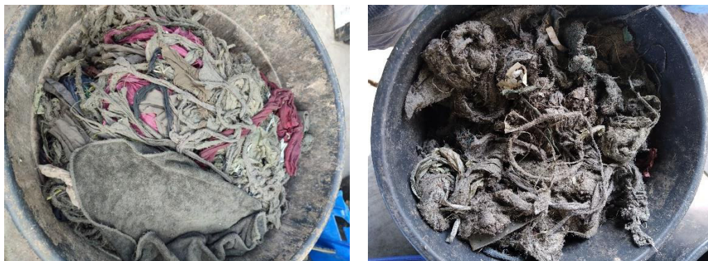
Figure 39. Exemples de textiles présents au sein des refus : à gauche > 100 mm et à droite entre 20 et 100 mm
