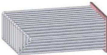
Figure 39 : Exemple de faisceaux vaporisateur horizontaux
