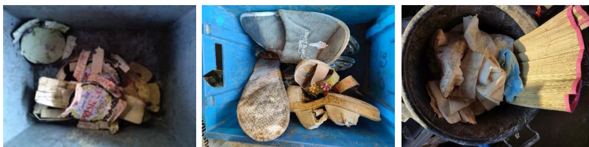
Figure 22. Exemples de combustibles présents au sein des OMR d'Organom : emballages en bois, chaussures et maroquinerie, autres combustibles.
