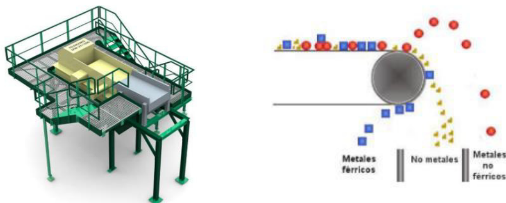
Figure 8 : Exemple de séparateur à courant de Foucault et du fonctionnement associé
