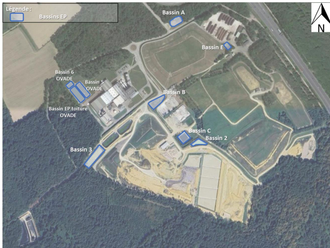
Figure 12 : Localisation des différents bassins des eaux pluviales du pôle de la Tienne
