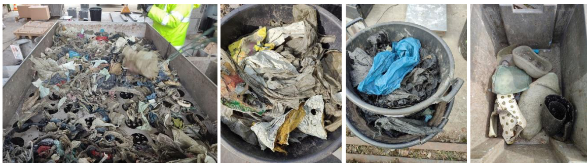
Figure 3. Exemples des étapes de criblage et de tri des éléments supérieurs à 100 mm : criblages, films plastiques d'emballages, sacs poubelles, autres plastiques.
