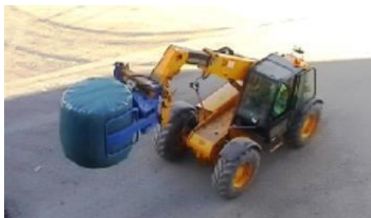
Figure 22 : Chargement d'une balle par un engin muni d'une pince à balles
