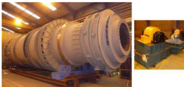
Figure 35 : Chemin de roulement de la cellule de combustion posés sur galets et châssis
