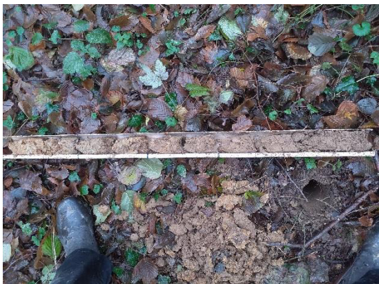
Planosols aux traits rédoxiques absents avant 25 cm, néanmoins interprétés comme humides, présent sur les sondages n°16,19,20,21,22. Il s'agit ici du profil du sondage n°22.
