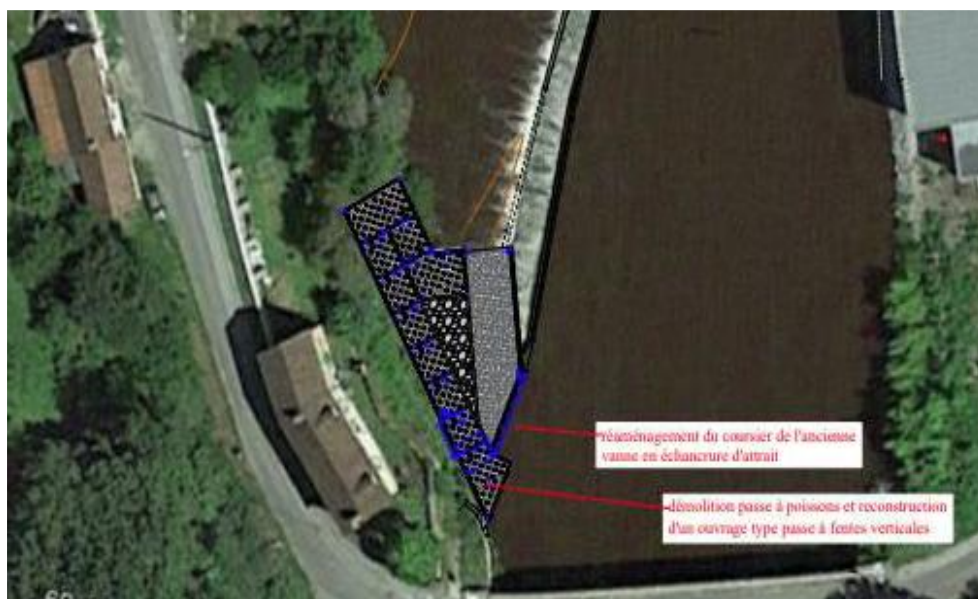
Construction de la passe à poissons et du chemin de portage des embarcations
