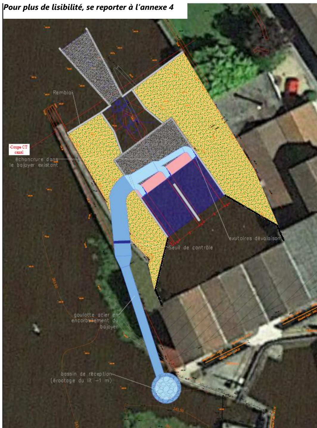
Figure 8. Vue en plan du dispositif de dévalaison
