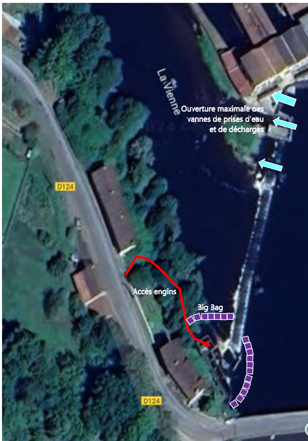
Figure 21 : conditions d'accès et e mise hors d'eau des travaux de construction de la passe à poissons
