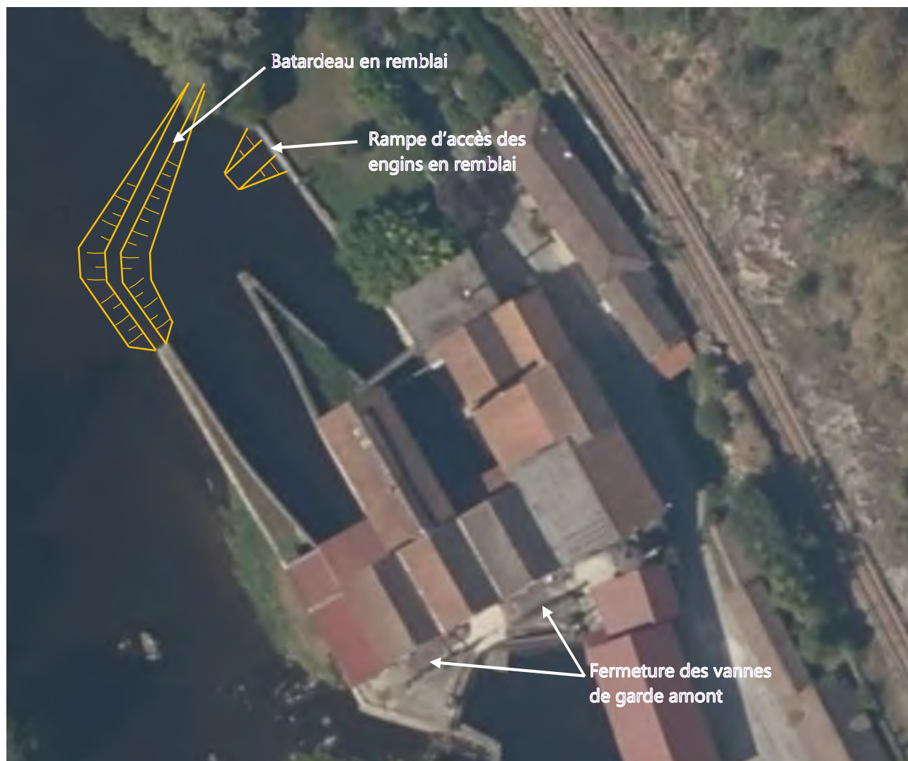
Figure 22 : conditions d'accès et e mise hors d'eau des travaux de construction de la centrale hydroélectrique
