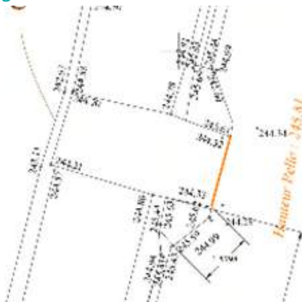
Figure 11 : plan coté de la vanne de vidange/décharge 2 existante (se reporter aux annexes graphiques pour une meilleure lisibilité)
