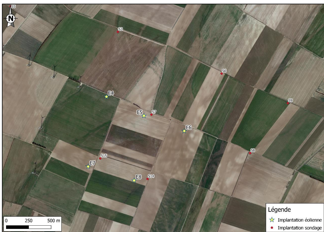
Figure 7 : Localisation des sondages sur le secteur central de l'emprise du projet (Source du fond de plan : IGN avec annotations GINGER BURGEAP)
