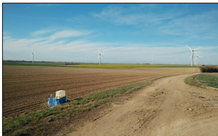
Photographie 1 : Test de perméabilité type Porchet en cours de saturation GINGER BURGEAP, 06/11/2018
