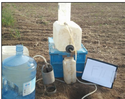
Photographie 13 : Sondage F11 en cours de mesure – GINGER BURGEAP, 08/11/2018
