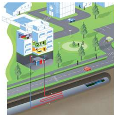
Principe de récupération de chaleur sur les eaux usées à l'échelle d'un bâtiment – Source : Biofluides
