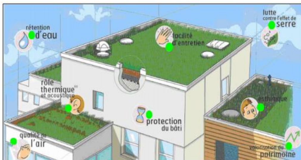
Figure 35 : Mesures d'aménagement des bâtiments avec toitures végétalisées
