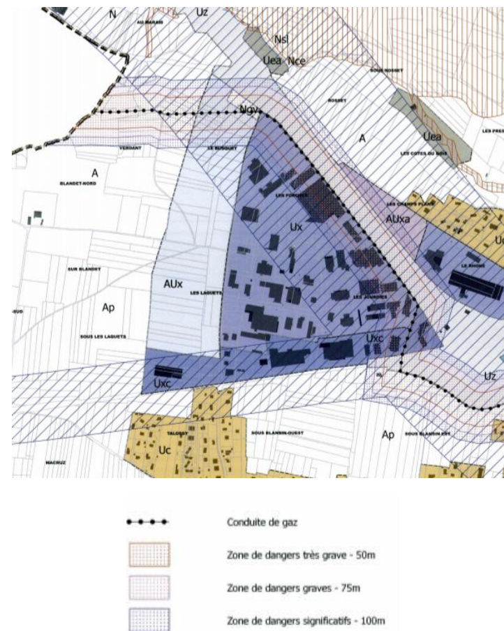
Localisation de la canalisation de gaz (Source : PLU de Saint-Pierre-en-Faucigny)
