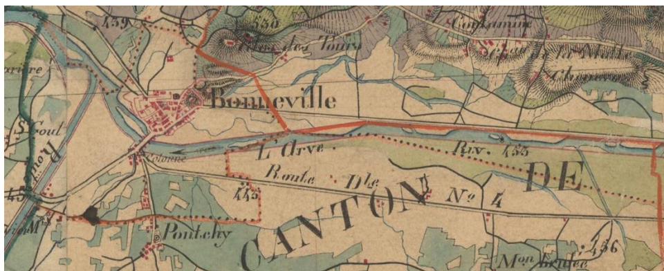
Carte Etat Major, 1866 : Les berges sont rectilignes, les dépôts solides sont symbolisés par une alternance de bancs alternés et d'îles.
