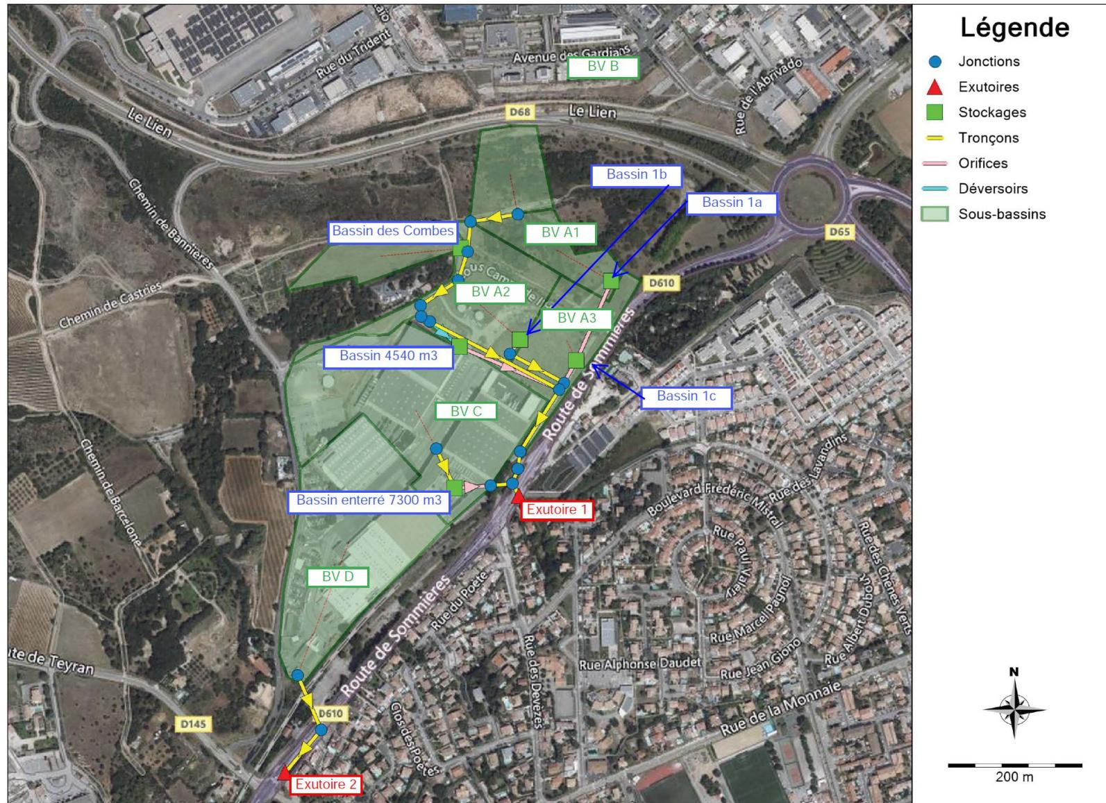
Figure 25 schéma synoptique de l'état projet modélisé (PCSWMM)
