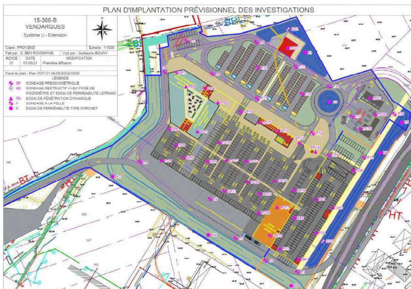
Figure 27 Plan d'implantation des essais de perméabilité (Source : EGSA btp) –Plan d'aménagement du projet Campus U indicatif
