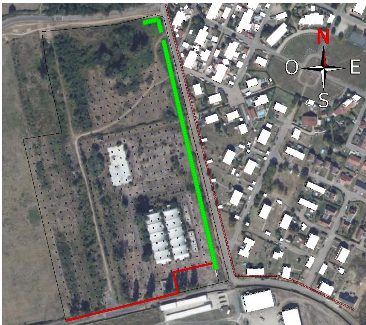
Figure 30 : Tracé de l'écran modélisé – hauteur : 4 m (en vert) - hauteur : 4 m (en rouge)
