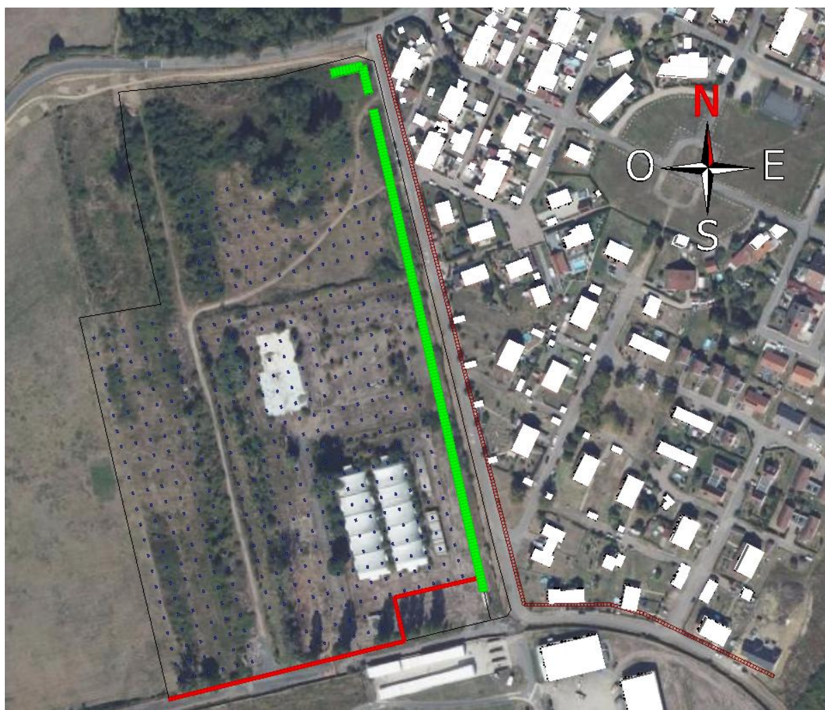
Figure 20 : Tracé de l'écran modélisé – hauteur : 4 m (en vert) - hauteur : 1 m (en rouge)
