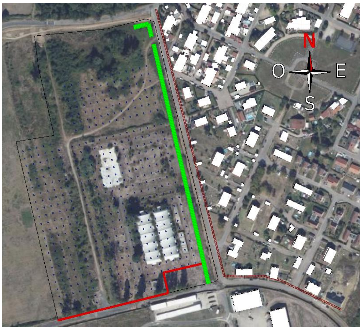
Figure 25 : Tracé de l'écran modélisé – hauteur : 4 m (en vert) - hauteur : 1 m (en rouge)
