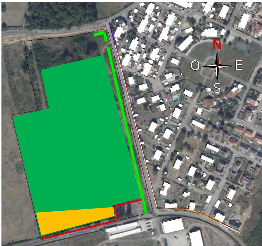
Figure 27 : Localisation des zones de la centrale sources de risque (en orange) ou non (en vert)
