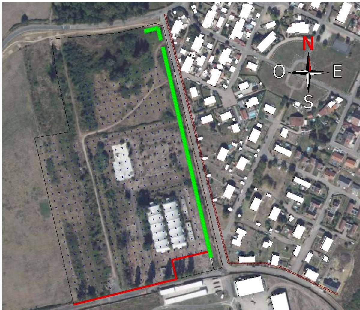
Figure 15 : Tracé de l'écran modélisé – hauteur : 3 m (en vert) - hauteur : 1 m (en rouge)
