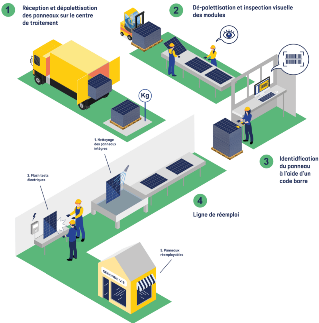
Figure 27 - Schéma du cycle de traitement des matériaux issus des centrales solaires (Source : SOREN, 2024)
