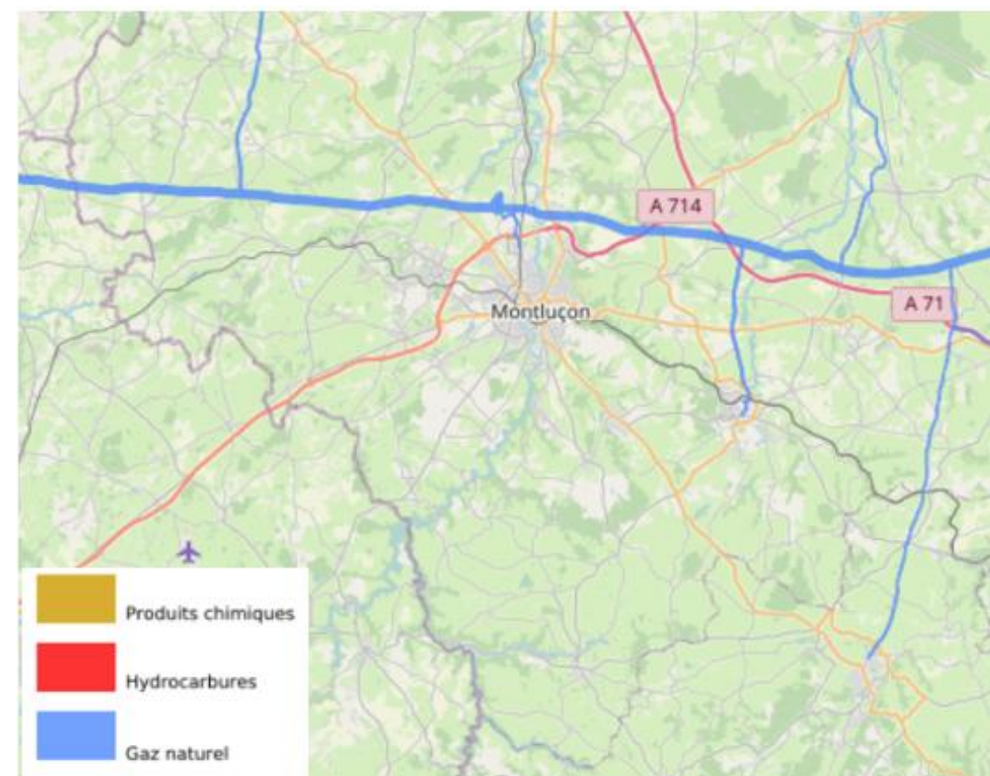
Figure 73 : Canalisations de produits dangereux à proximité du site
