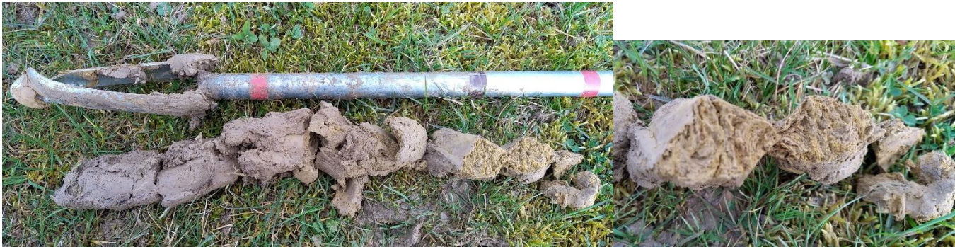
Figure 53 : Echantillon rédoxique caractéristique d'une zone humide (DCI Environnement)
