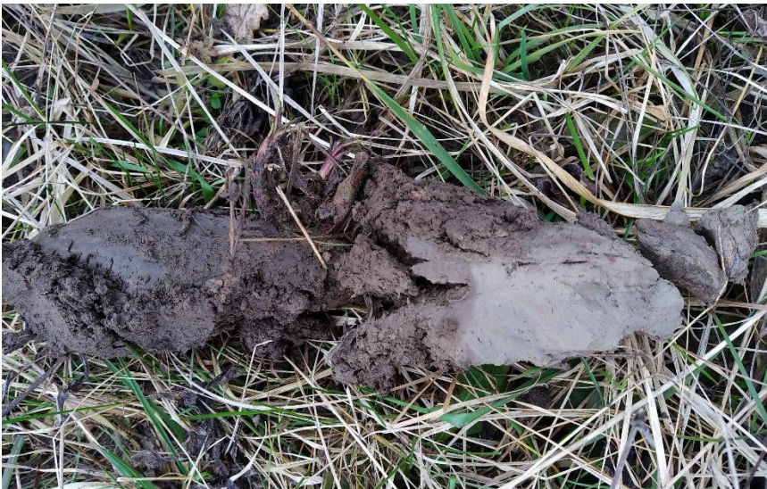
Figure 54 : Echantillon d'un horizon histique puis réductique caractéristique d'une zone humide (DCI Environnement)
