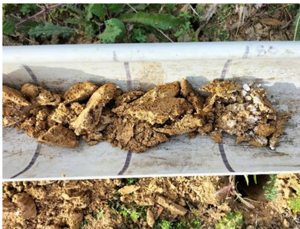
Contact entre un horizon BTg et une couche IIMg
