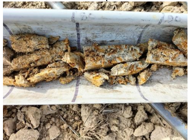
Bariolage de veines ocres et blanches, signe d'une hydromorphie intense au sein d'un horizon BTg
