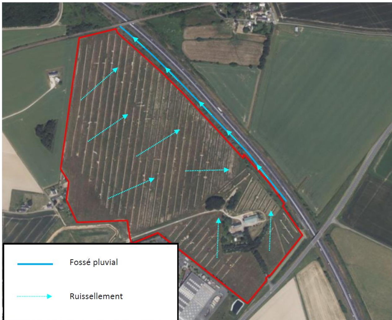
Figure 32 : Hydraulique du site de la Pérauderie à l'état initial (source : CERRETTI)
