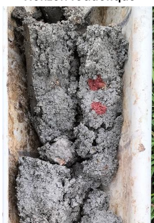
Horizon réductique mis en évidence par l'orthophénantroline
