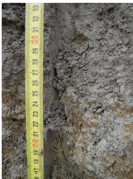
Figure 26 : Exemple transition entre l'horizon superficiel et l'horizon plus profond hydromorphe
