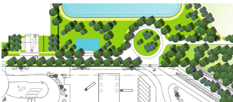
Zoom sur le traitement du retournement prévu à l'extrémité de la voie de desserte interne, au droit du bassin n°2.
