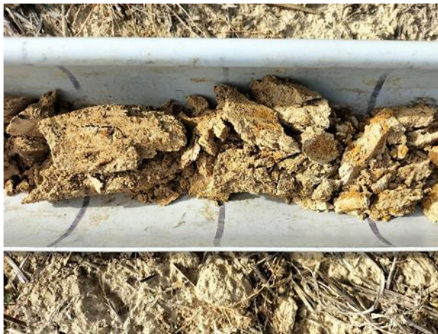
Horizon Eg d'un LUVISOL TYPIQUE REDOXISOL
