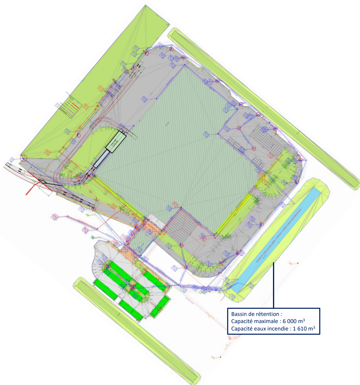
Figure 3 : Plan de masse du projet et localisation du bassin de rétention (source : EIFFAGE CONSTRUCTION TOURS)
