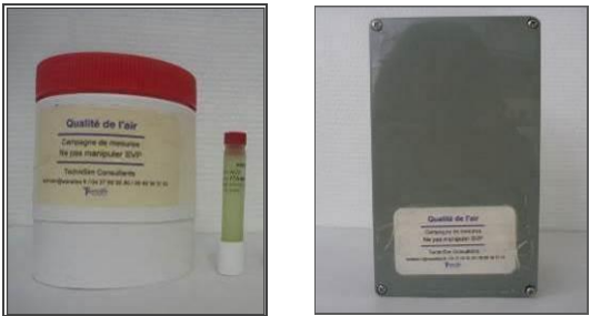
Figure 30 : Réceptacle et tube passif pour NO 2 et micro-capteur laser
