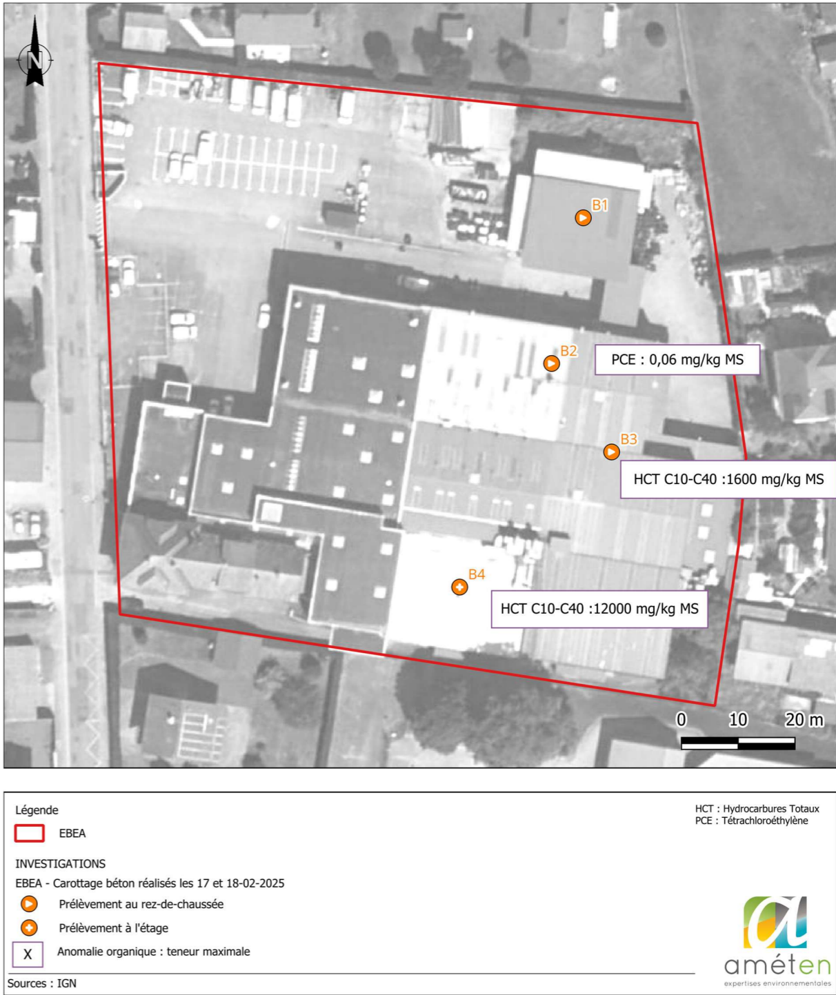
Figure 7 : Anomalie au droit des dalles bétons (Source : Diagnostic de la qualité environnementale des milieux – prestation globale DIAG – Dossier 24-586-e en date du 28/03/2025)
