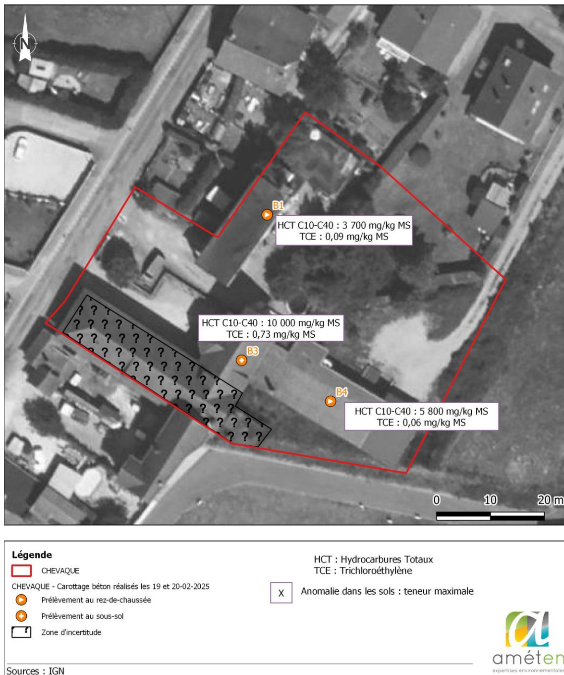
Figure 5 : Anomalie au droit des dalles bétons (Source : Diagnostic de la qualité environnementale des milieux – prestation globale DIAG – Dossier 24-586-d en date du 27/03/2025)
