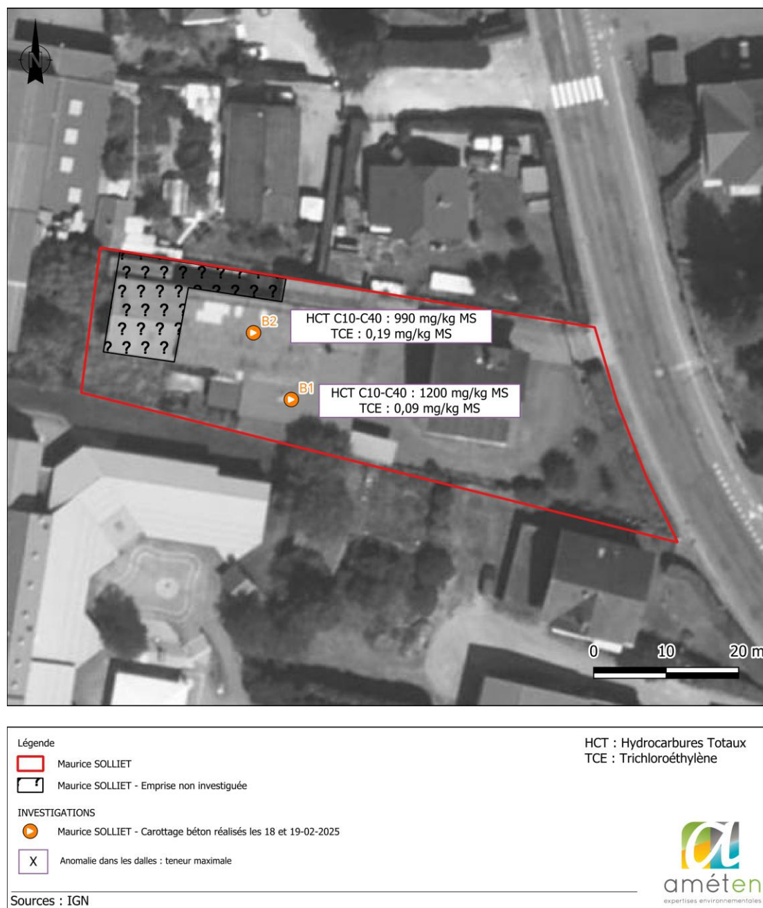
Figure 7 : Anomalie au droit des dalles bétons
