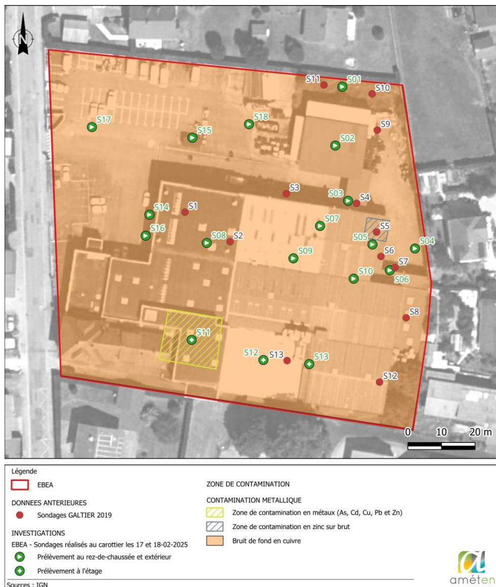
Figure 11 : Zone de contamination métallique au droit des sols
