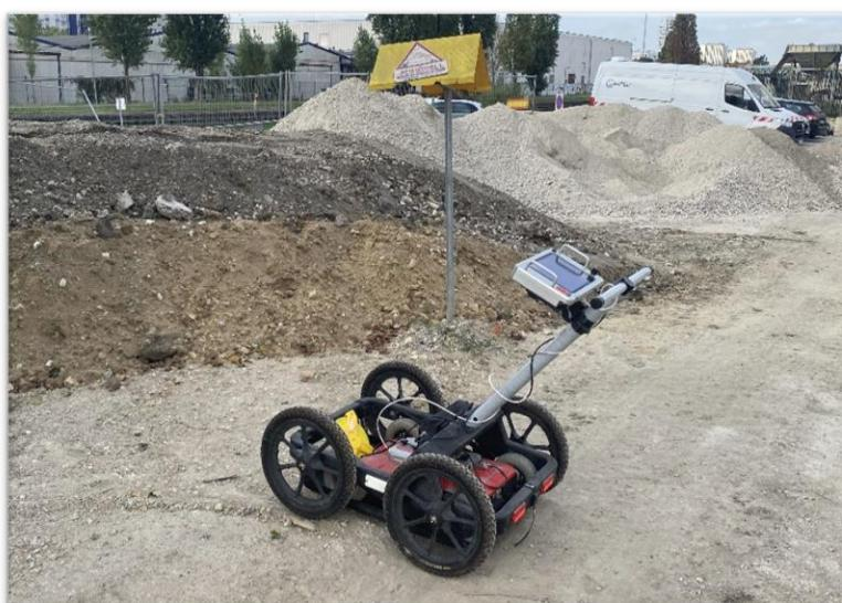
Figure 5 : Photographie du radar MALÅ
