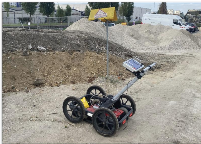
Figure 5 : Photographie du radar MALÅ
