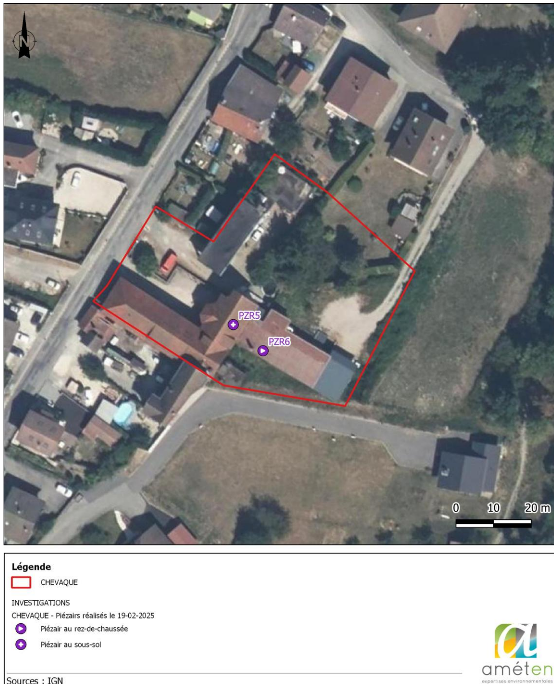
Figure 5 : Cartographie des piézairs mis en place le 19/02/2025
