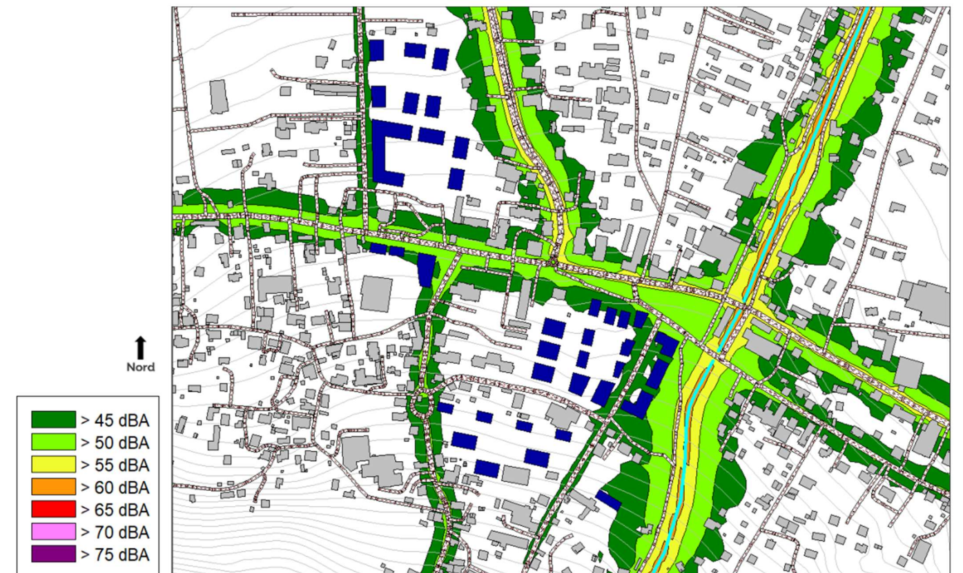
Cartographie sonore en dBA à 4m au-dessus du sol – Etat Futur avec projet – Période 22h-6h – Source : VENATHEC
