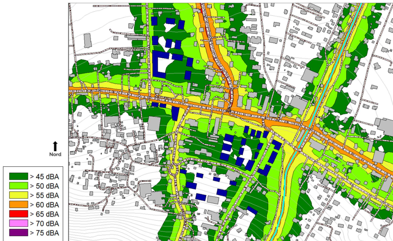
Cartographie sonore en dBA à 4m au-dessus du sol – Etat Futur avec projet – Période 6h-22h – Source : VENATHEC
