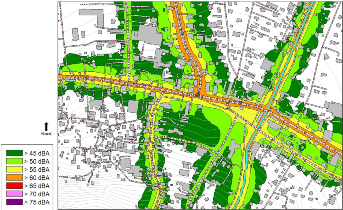
Cartographie sonore en dBA à 4m au-dessus du sol (Etat initial – Période 6h-22h) – Source : VENATHEC
