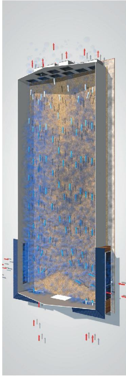
Une répartition optimale de l'eau à travers les Pads
