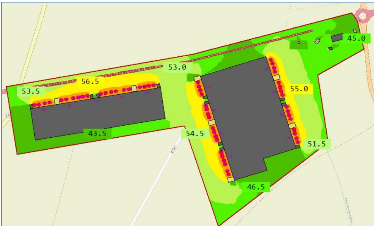
Figure 62 : Propagation du bruit modélisé par AcoustiControl, septembre 2023
