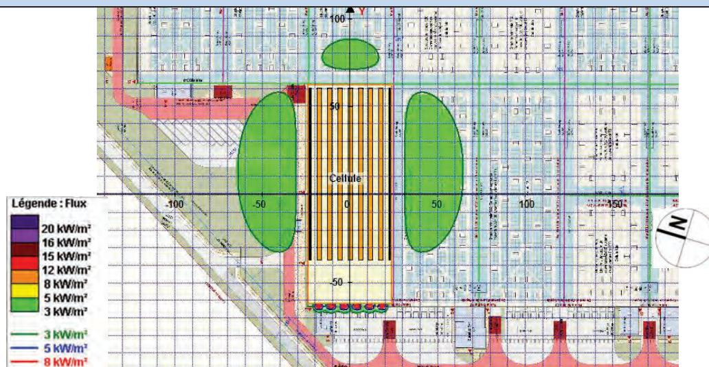
Figure 37 : Incendie de la cellule 15 – palette LC/SLC -Modélisation sans le retour CF en façade de 6 m à droite et 15m à gauche.
