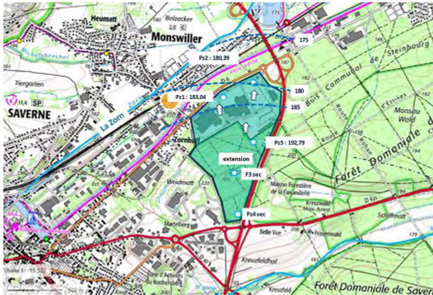
FIGURE 7 : PIEZOMETRIE ET SENS D'ECOULEMENT DE LA NAPPE DES ALLUVIONS
