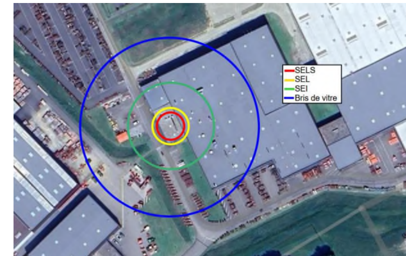
Illustration n° 15 : Intensité des effets de l'explosion de la chaufferie
