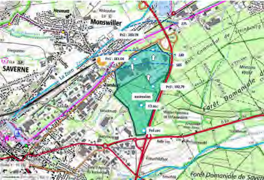
FIGURE 7 : PIEZOMETRIE ET SENS D'ÉCOULEMENT DE LA NAPPE DES ALLUVIONS
