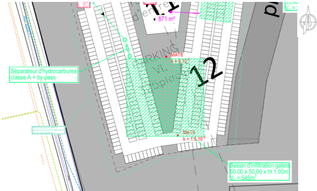
FIGURE 28 : BASSIN D'INFILTRATION GENERAL DE L'EXTENSION SUD - EXTRAIT DU PLAN DES RESEAUX HUMIDES (SOURCE : OTE, JUIN 2024)
