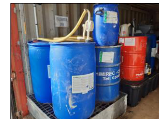
Stockage sur rétention
