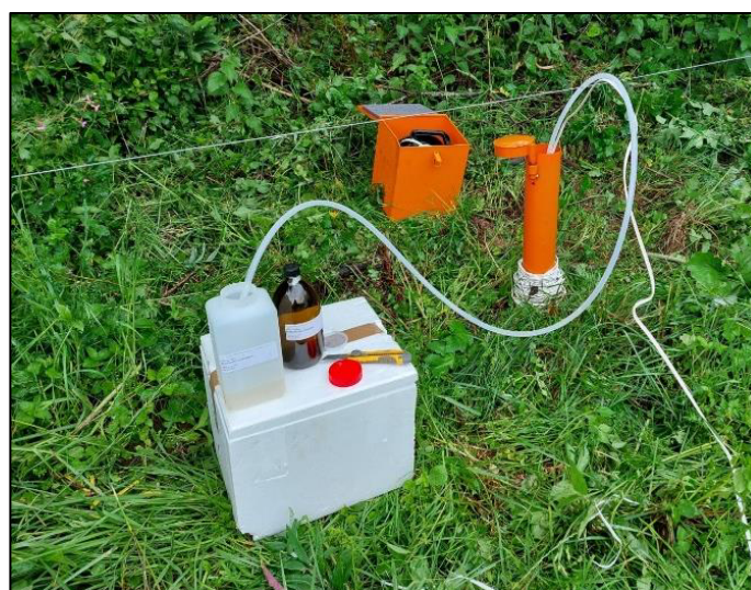
Figure 7 : Prélèvement d'échantillon dans le piézomètre
