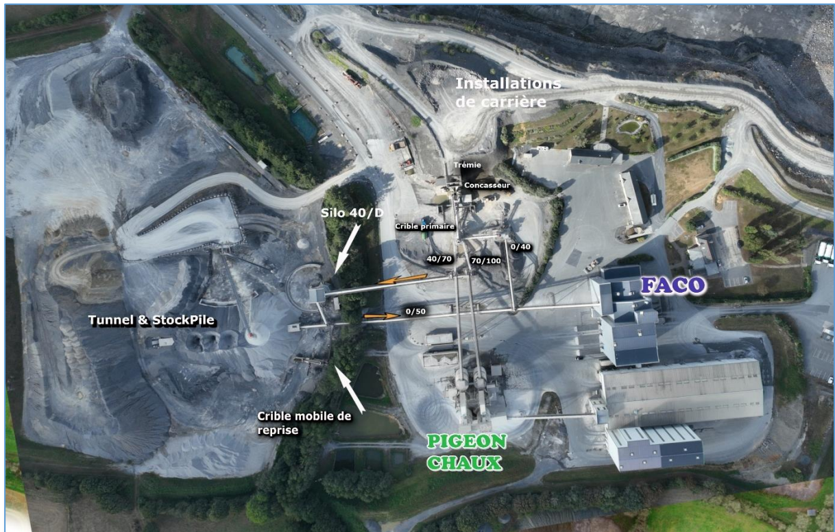
Fig. 102 : Synoptique simplifié des installations présentes sur le site
