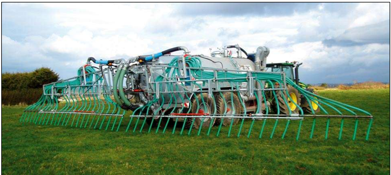
Photo 6.1 : Exemple de tonne à lisier munie d'une rampe à pendillards
