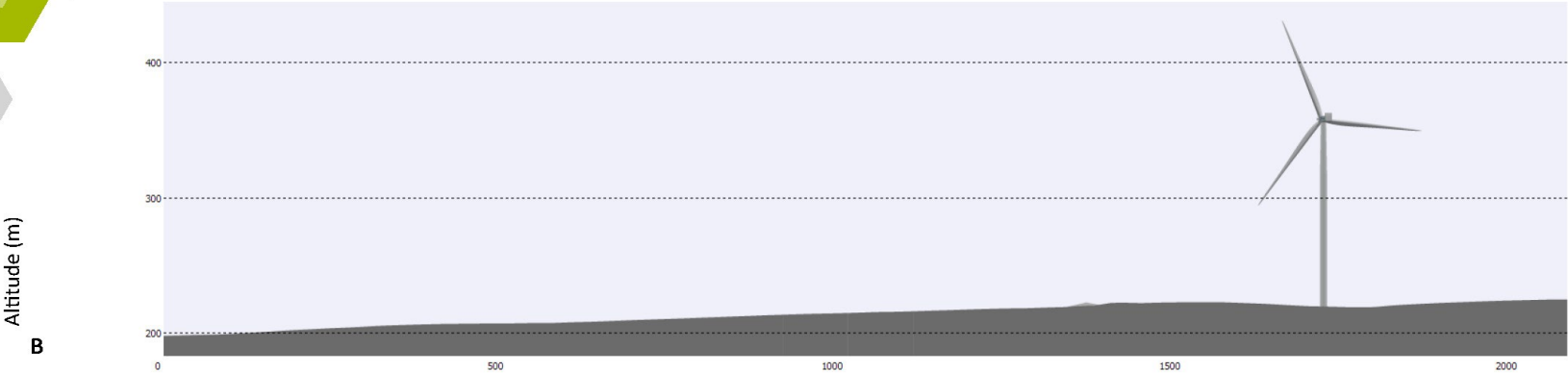
Coupe topographique ayant pour éolienne de référence E1 avec une zone de recul de 500 m. Echelle verticale dilatée x2
