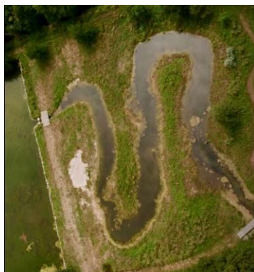
Vue aérienne de travaux de création d'une zone humide en queue d'étang – après végétalisation (Srce : SMVA)
