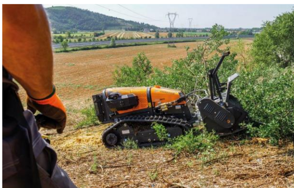
Exemple de broyeur télécommandé (Srce : GC Service Forestier)
