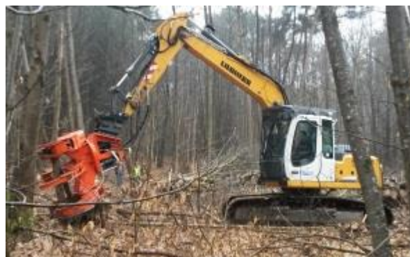
Exemple de pelles avec chenilles et/ou patins caoutchoucs équipées pince cisaille (Srce : GC Service Forestier)
