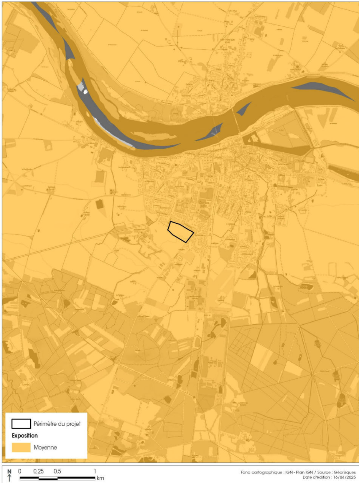
Figure 19 : Exposition au retrait-gonflement des argiles au droit de l'aire d'étude immédiate
