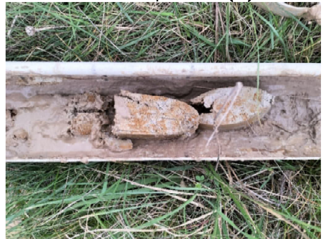
Transition brutale entre un horizon sableux noyé et un horizon argileux (S3)
