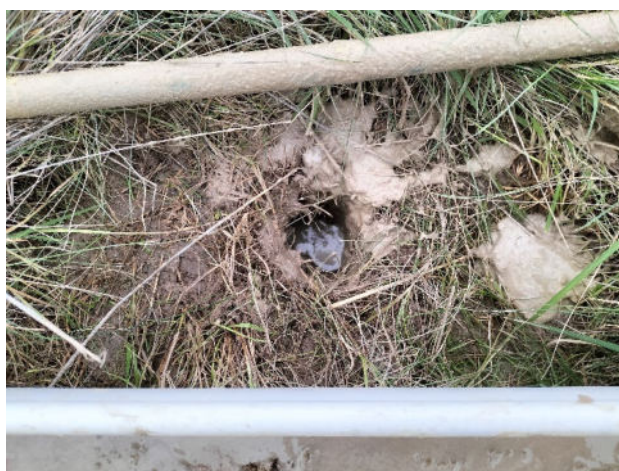
Sondage avec nappe à l'équilibre en surface (S5)
