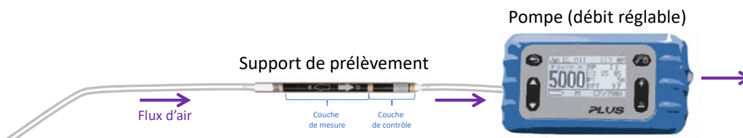
Figure 5 : Schéma de principe du prélèvement actif
