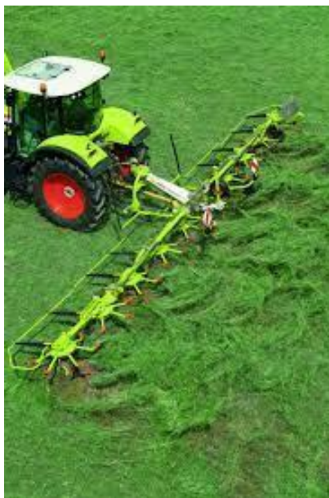
Figure 23 : Faneuse portée grande largeur
