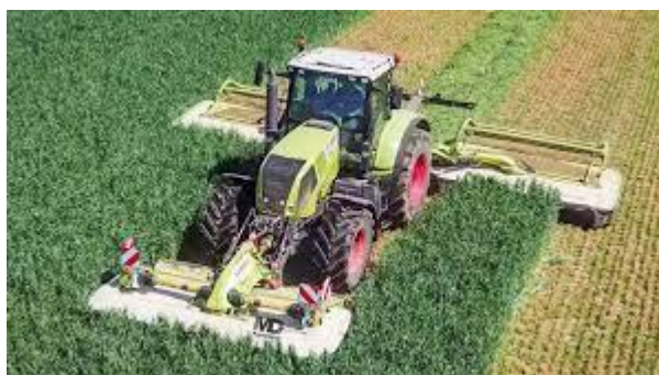
Figure 21 : Groupe de fauche : frontale + 2 latérales, avec ameneur central
