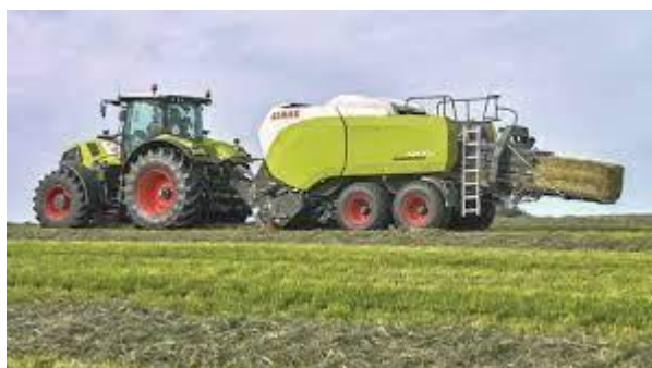
Figure 28 : Presse à balles rectangulaires
