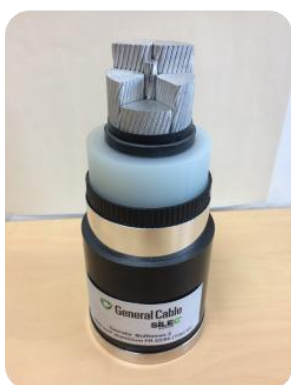
Détail de la structure d'un câble souterrain.
