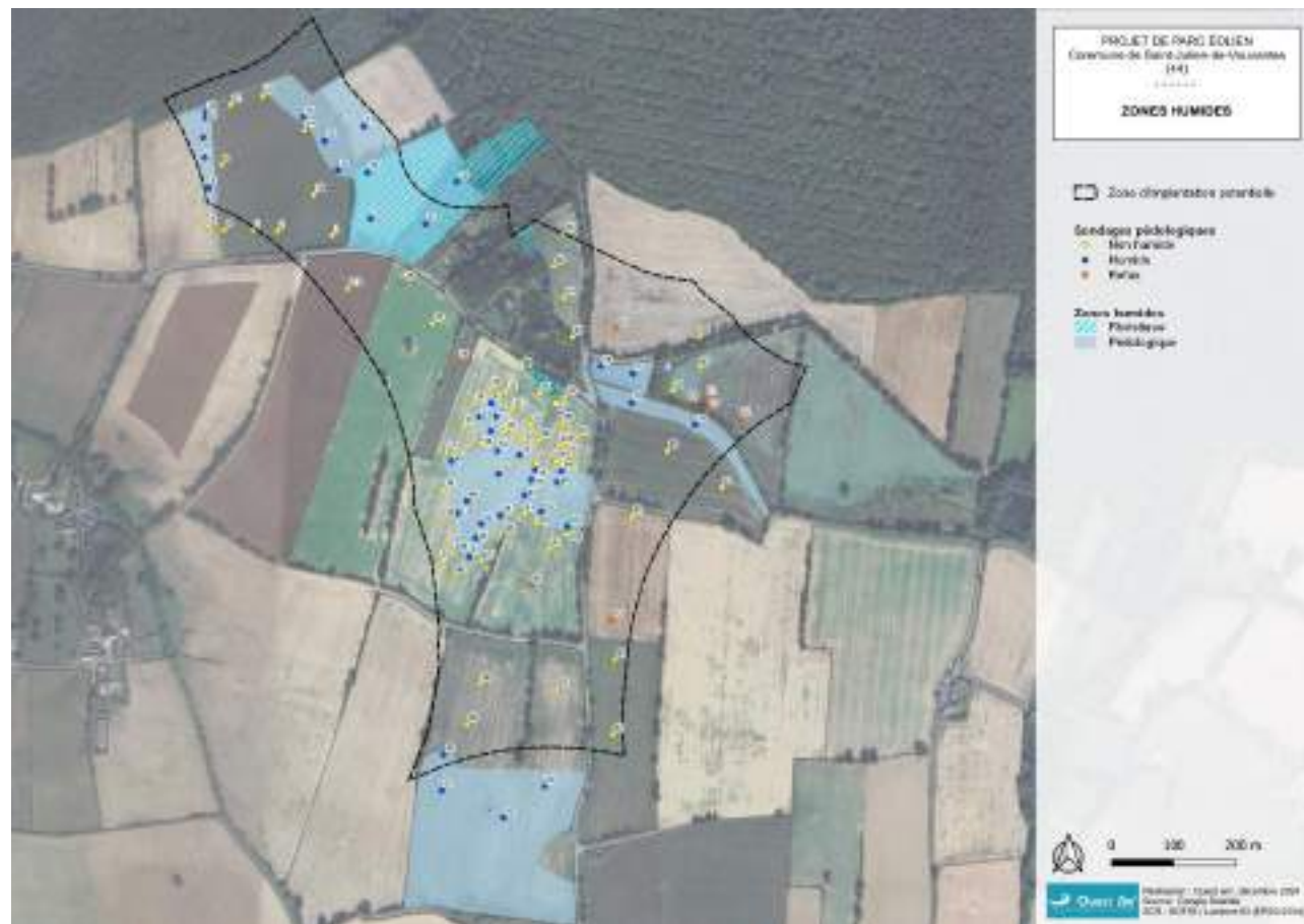
Figure 10 : localisation des sondages pédologiques au niveau du site compensatoire
