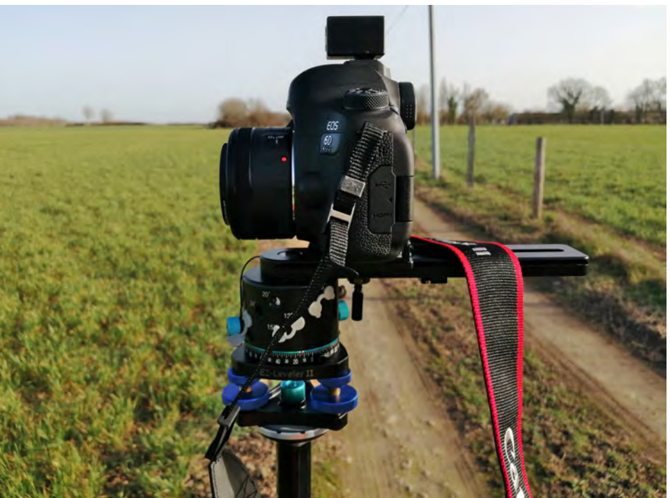
Figure 8 : Installation pour prise de vue panoramique
