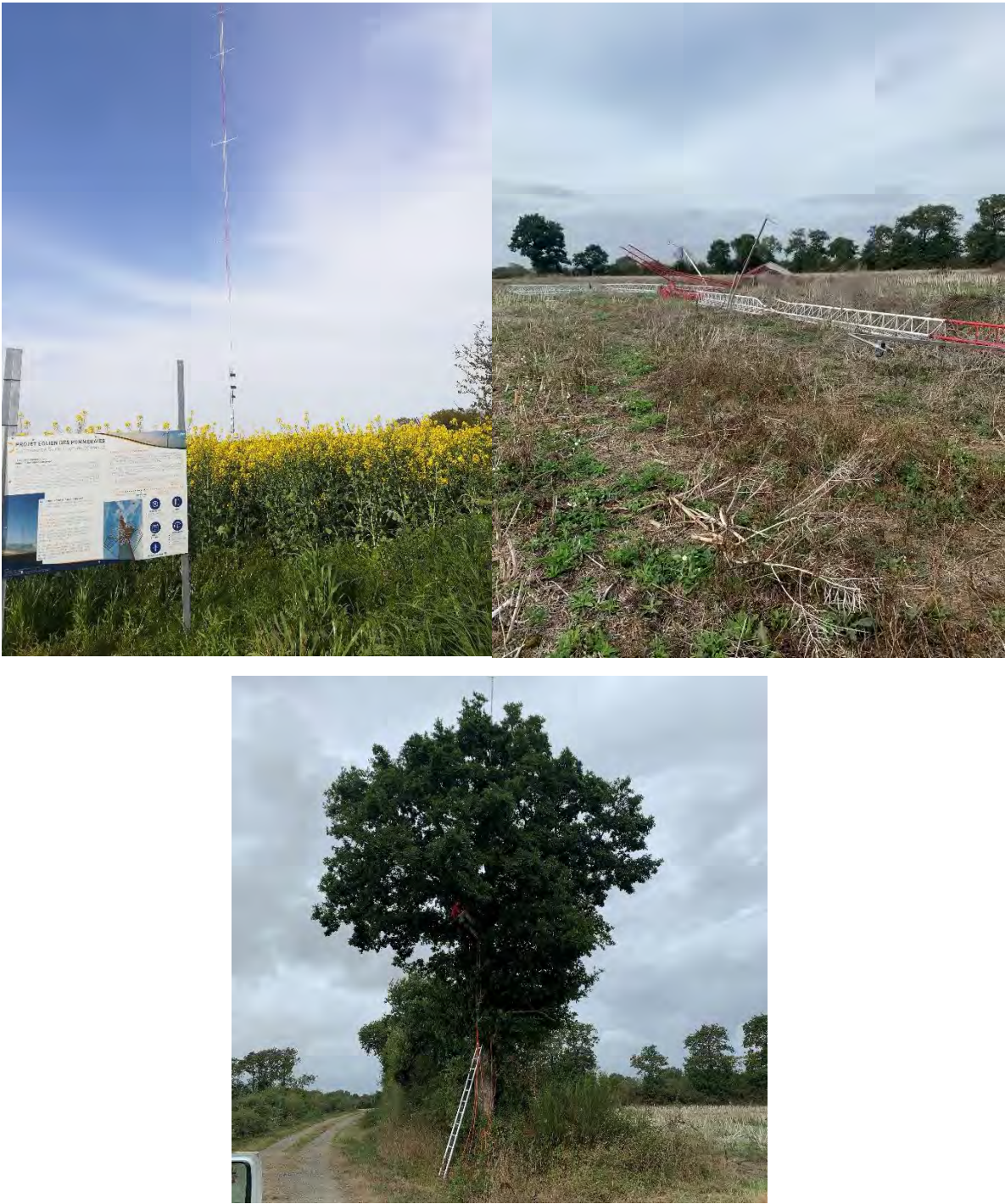
Figure 46. Installation de l'enregistreur sur mât et sur perche
