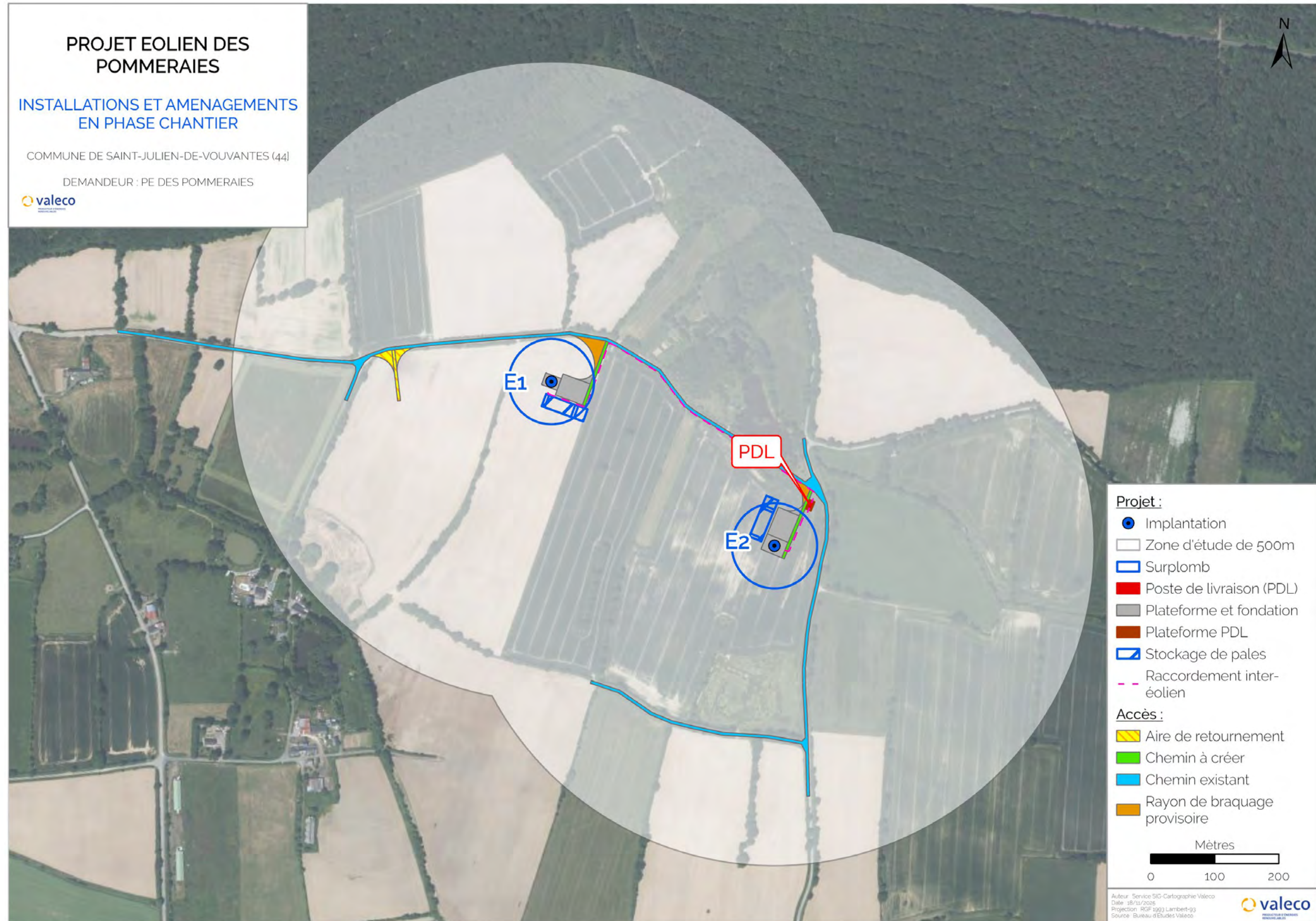
Figure 72 : Installations et aménagements en phase chantier (Source : VALECO)
