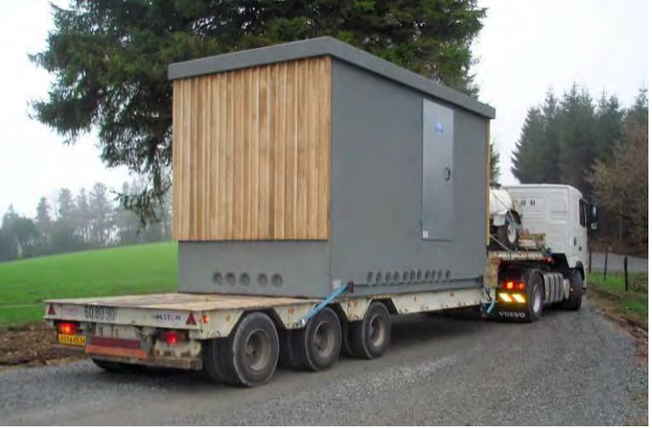
Figure 79 : Arrivée d'un poste de livraison sur un site éolien (Source : VALECO)
