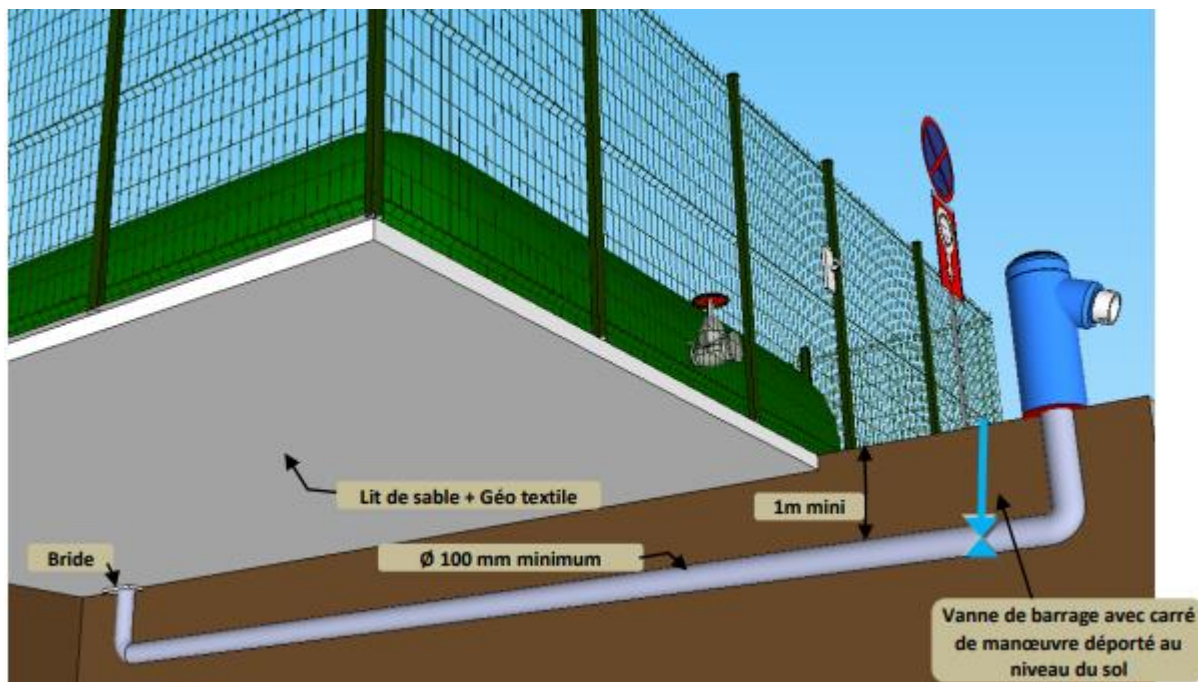
FIGURE 9 : EXEMPLE DE SCHEMA D'UNE AIRE D'ASPIRATION SUR BACHE INCENDIE.
